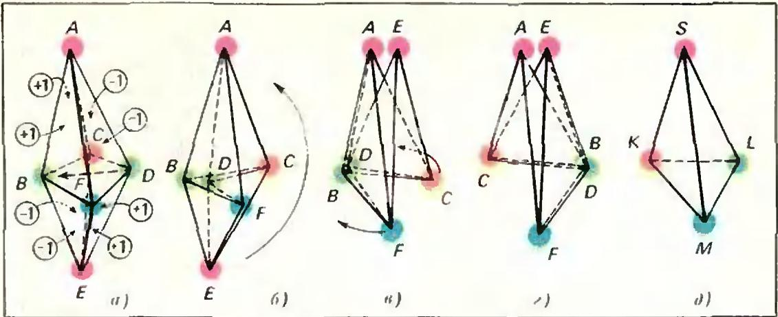
Рис. 8. Процесс наложения поверхности октаэдра на поверхность тетраэдра.
